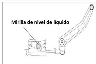
Ajuste la colocación del vehículo para que el líquido de frenos esté en posición horizontal, y compruebe su nivel a través de la mirilla del nivel de líquido.
