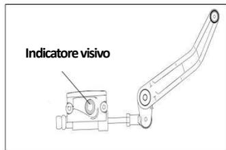
Figura 30 Controllo livello liquido freno
