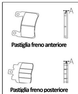
Controllare lo spessore minimo delle pastiglie del freno (A).
