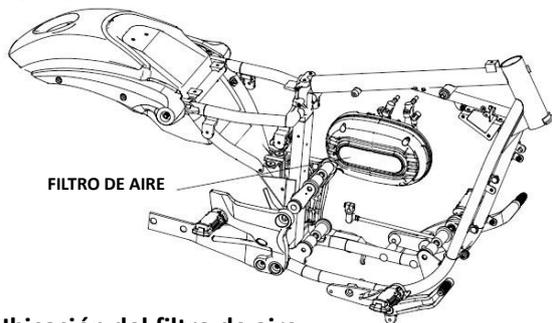
1. Retire los 4 tornillos de la tapa lateral del filtro de aire y los tornillos de fijación del elemento filtrante. Retire el elemento filtrante.
