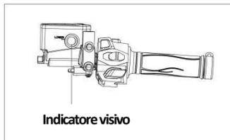
Posizionare il veicolo di modo che il liquido dei freni sia orizzontale e controllare il livello tramite l'apposito indicatore visivo. (Figura 26)
