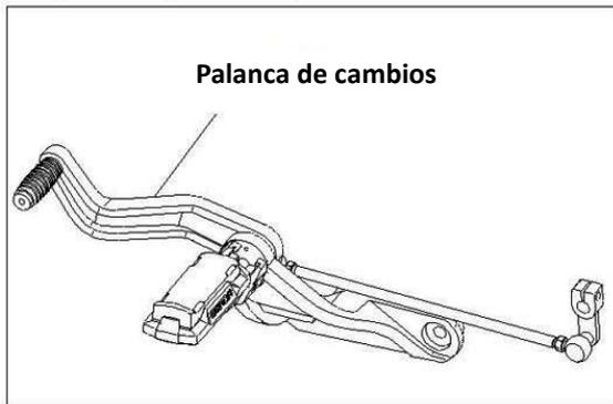
Fig.13 Palanca de cambios
