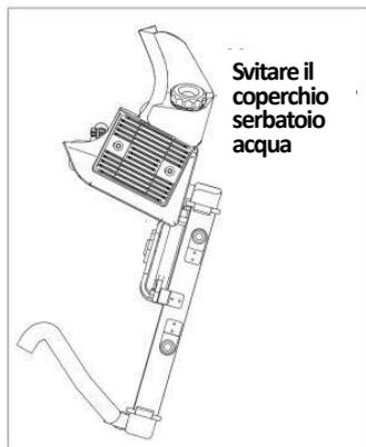
Figura 33 Aggiunta di liquido di raffreddamento
