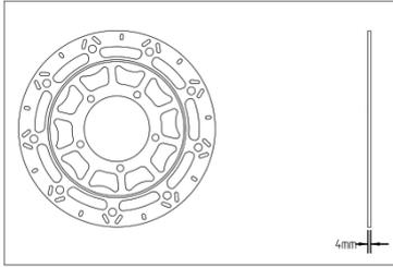
Figura 24 Inspección del disco de freno delantero
