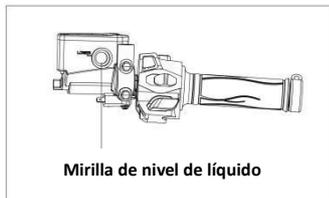
Ajuste la colocación del vehículo para que el líquido de frenos esté en posición horizontal, y compruebe su nivel a través de la mirilla del nivel de líquido. (Figura 26)
