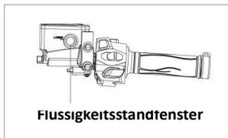
Abbildung 26 Kontrolle des vorderen Bremsflüssigkeitsstands
