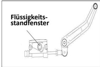
Stellen Sie das Fahrzeug so auf, dass sich die Bremsflüssigkeit in der Bremsanlage in einer waagerechten Position befindet, und prüfen Sie den Bremsflüssigkeitsstand durch das Flüssigkeitsstandsfenster.
