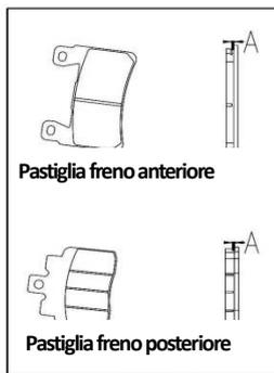
Controllare lo spessore minimo delle pastiglie del freno (A).
