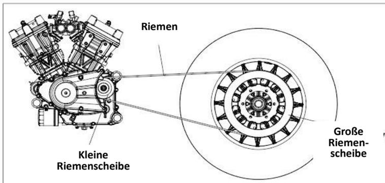
Abbildung 21 Riemenantrieb
