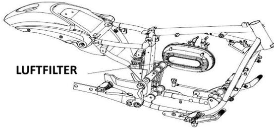
1. Entfernen Sie die 4 Schrauben der Seitenabdeckung des Luftfilters und die Befestigungsschrauben des Filterelements. Nehmen Sie den Filtereinsatz heraus.
